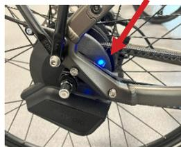
1. Após descarregar a aplicação, emparelhe o seu telefone **via Bluetooth com o desviador traseiro AUTOMATI*Q*.** Para iniciar o emparelhamento do dispositivo, prima e mantenha premido o botão no dispositivo. Quando o botão piscar a azul, o dispositivo estará no modo de emparelhamento.
